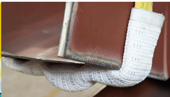
Schnittfester Kantenschutz aus «Aramid» (Spezialgewebe)
