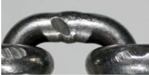
Kerben durch mechanische Einwirkung
