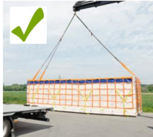
Entladesystem Stand der Technik mit 2 Hebebändern und Netz zur Ladungssicherung
