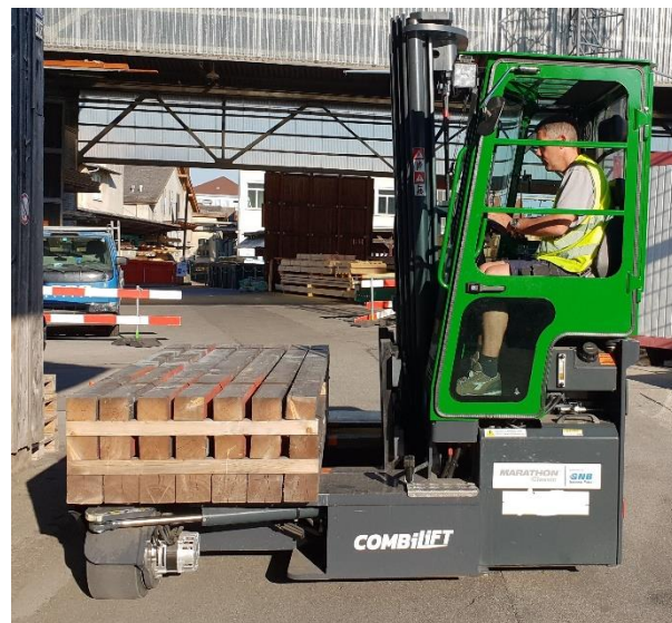
Dreirad Vierwegestapler für den Aussenbereich
