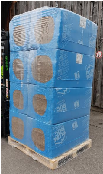
Umwickeln mit Dehnfolie
