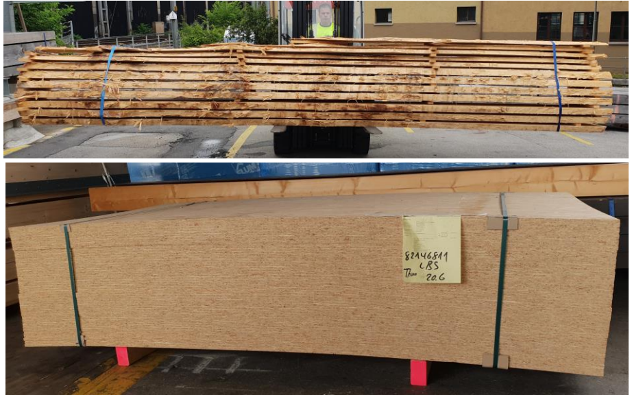
Umreifen oder Verzurren mit Spanngurten
