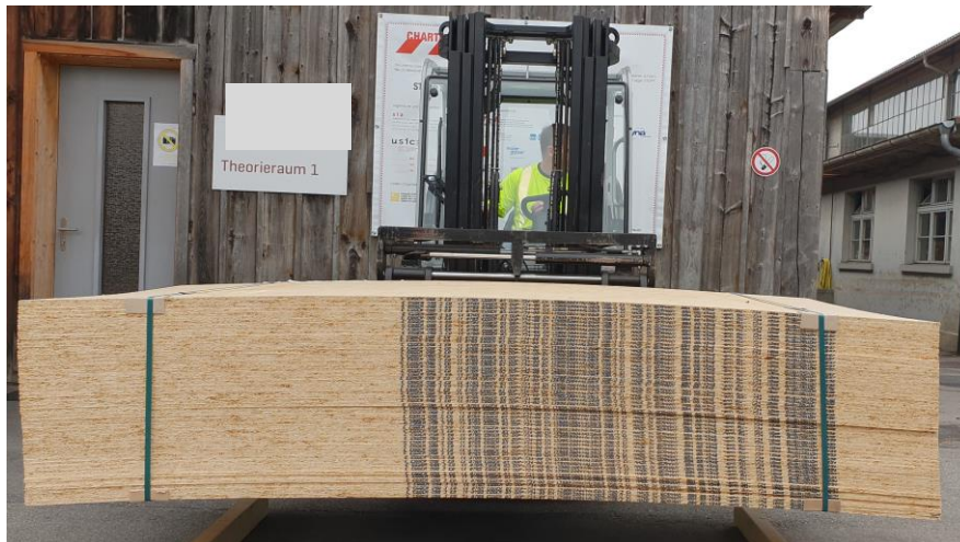
Unstabile Lasten müssen zusammengebunden werden
