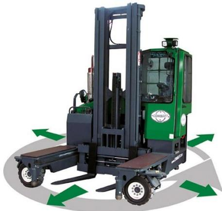
Mit dem Fahrrichtungsschalter können die Räder um 90° gedreht werden. Die Fahrtrichtung kann also entsprechend gewählt werden.
