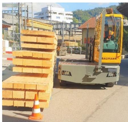
Erst losfahren, wenn die Gabel bis in den Rahmeneinschnitt abgesenkt ist und die Plattform parallel zum Fahrweg steht.
