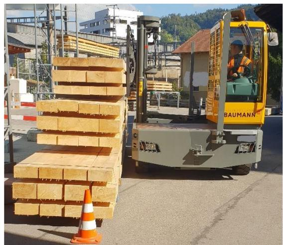
4. Last auf dem Stapel genau ausrichten und Hubmast einziehen. Gabel absenken.
