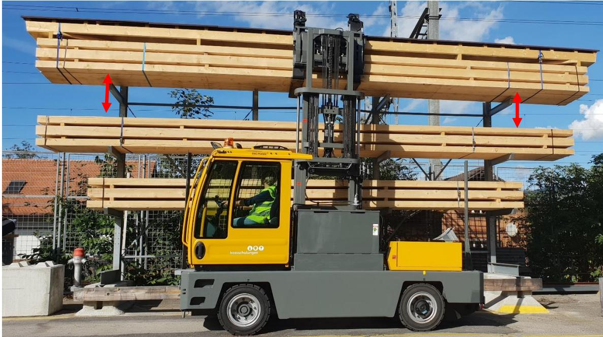
Falls nötig, muss mit der Funktion „Einzelgabelhub“ die horizontale Position ausgeglichen werden. **Vorsicht:** Einzelgabelhub nur direkt über der Plattform oder direkt über den Kragarmen betätigen! Ist die Last freihängend, kann sie bei einer ruckartigen Betätigung der einzelnen Gabel abrutschen.
