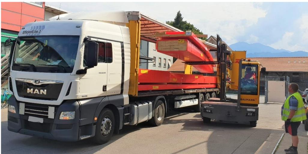
Lasten vorsichtig aus dem Auflieger manövrieren und anschliessend auf die Plattform absenken. Last nach dem „Ausfädeln“ aus dem Auflieger mit den hydraulischen Schubgabeln sofort an den Gabelrücken ziehen.
