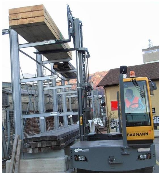
Keinesfalls dürfen schwere Lasten unkontrolliert auf den Gabeln ausgefahren werden. Der Stapler kann sonst umstürzen.
