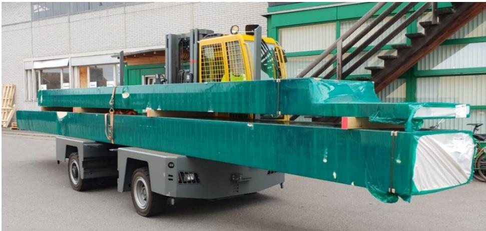
Beim Einlegen der Zwischenlagen muss die Last immer auf der Plattform des Staplers aufliegen.
