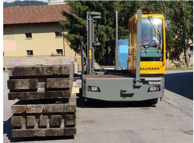
2. Plattformneigung der Last angepasst ausnivellieren und Mast ausfahren.
