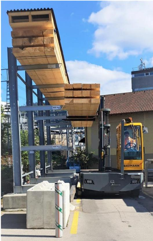
3. Plattform waagrecht stellen und anschliessend das Hubgerüst ausfahren.
