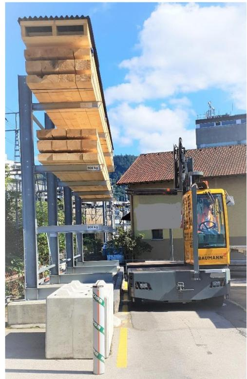
6. Hubmast einziehen, Plattform aufneigen und Gabel absenken. Erst losfahren, wenn die Gabel im Rahmeneinschnitt ist.
