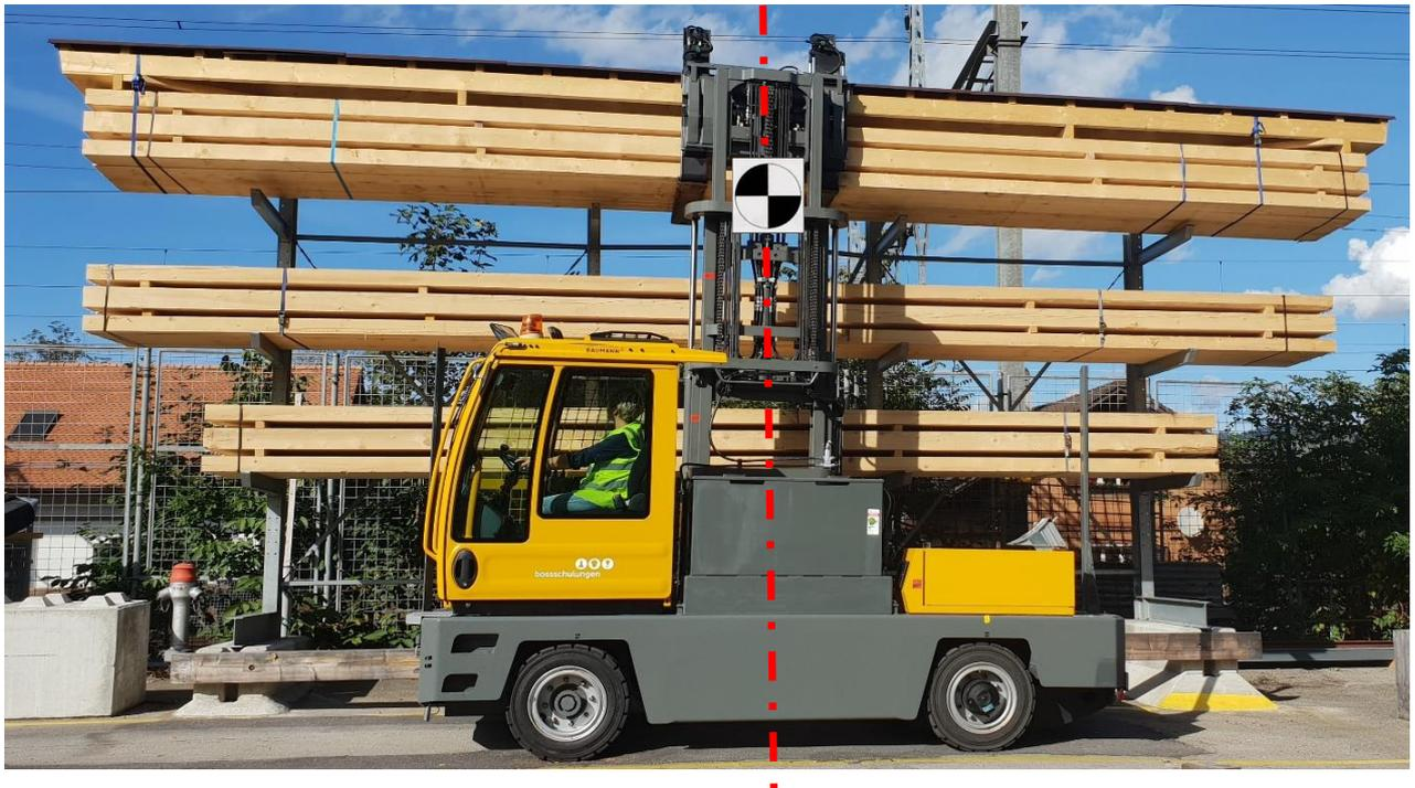
Lasten, insbesondere Langmaterial, müssen so aufgenommen werden, dass die Gabeln je die Hälfte der Last übernehmen müssen. **Der Schwerpunkt der Last** muss genau in der Mitte des Hubmastes liegen. Die Last allenfalls vor der Aufnahme messen und die Mitte markieren.
