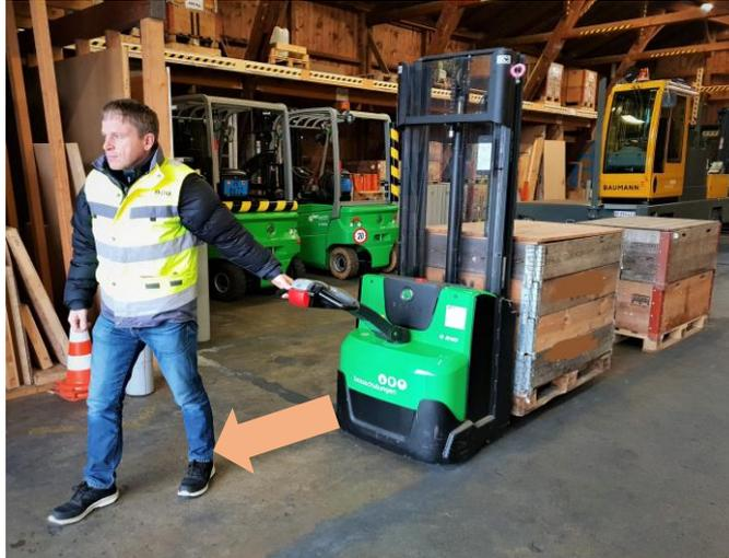
Wenn möglich Vorwärts gehen. Der Geräteführer hat so die beste Übersicht der Fahrstrecke. Der führende Arm ist immer gestreckt. Dadurch wird der Abstand der Füße zum Gerät gross genug gehalten.
