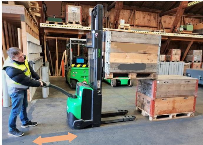
Zum Rückwärtsfahren und zum Manövrieren (Aufnehmen der Last) wird das Gerät beidhändig geführt.
