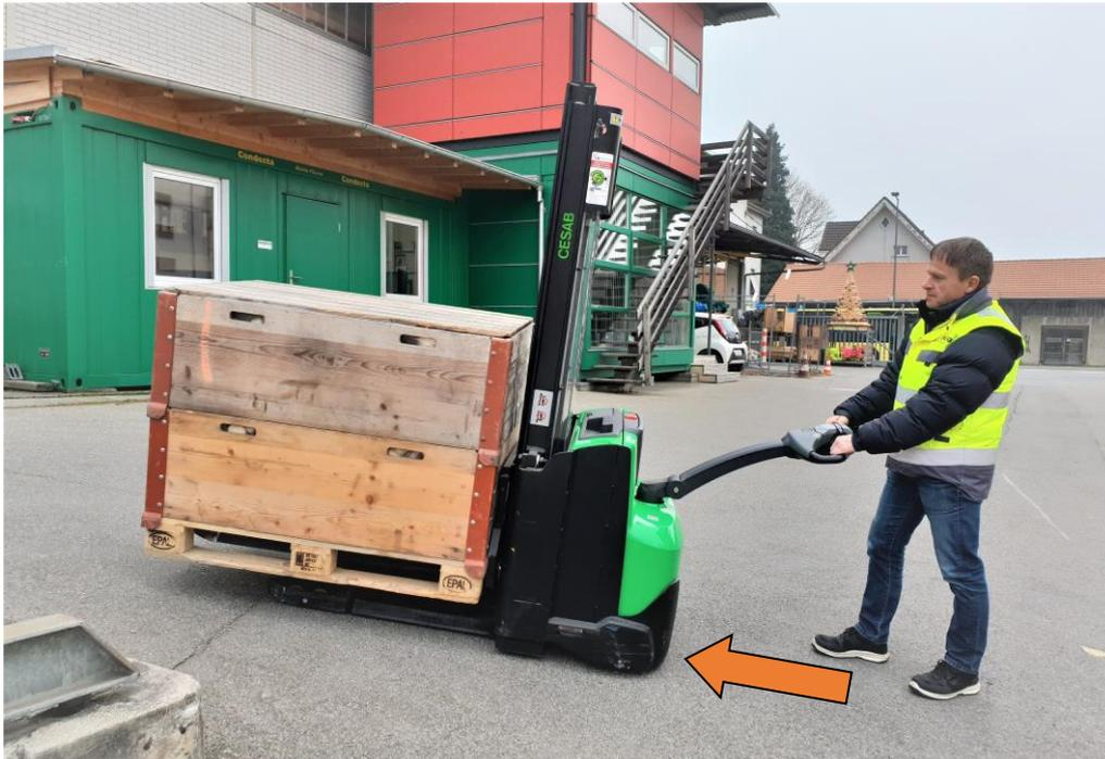
Beim Befahren einer Steigung muss die Last immer auf der Bergseite sein. Die maximale „Steigfähigkeit“ des Deichselstaplers ist gemäss den Vorschriften in der Betriebsanleitung zu beachten
