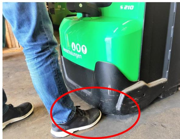
Steht der Geräteführer zu nahe, besteht die Gefahr des Einklemmens der Füße. **In jedem Fall muss der Geräteführer Schutzschuhe tragen.**
